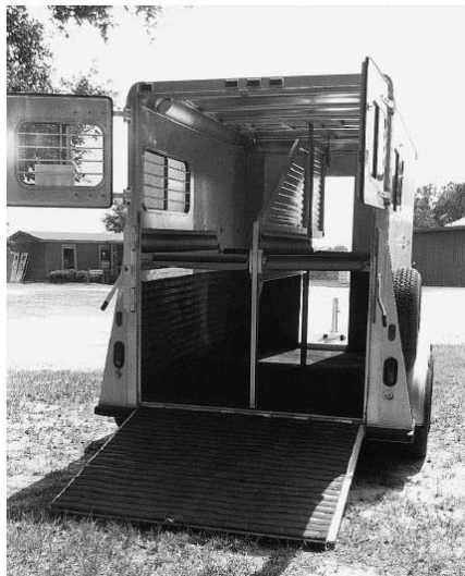
تریلر حمل ۲ اسب با ورودی رمپ (شیددار) و دو خروجی در جلو
